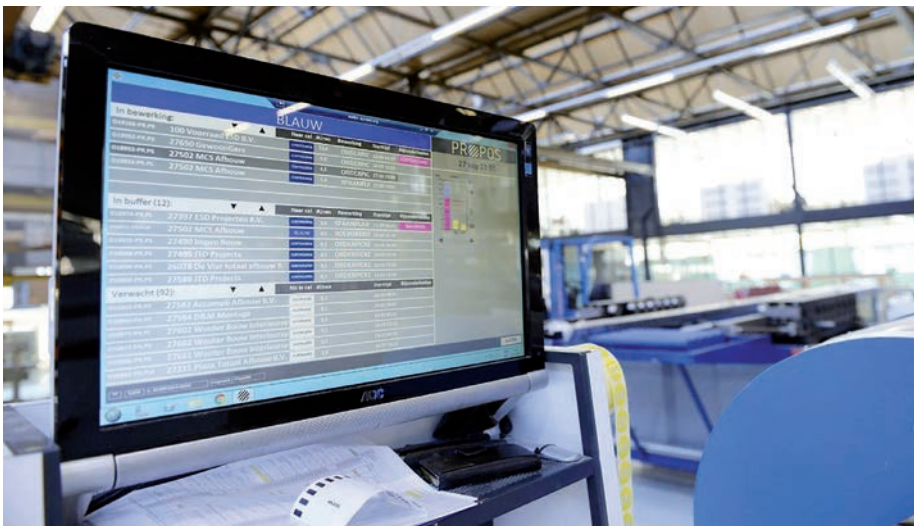
Bosch Scharnieren heeft QRM en POLCA geautomatiseerd met de in eigen huis gebouwde systeemsoftware van dochterbedrijf Propos Software.
